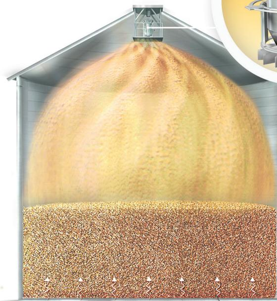
refroidissement par ventilation homogène
